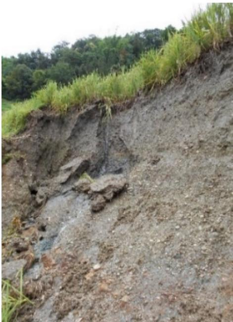
Fig. 3. Vue de profil d'une rizière écroulée, là où le sol saturé d'eau devient trop lourd pour le sous-sol desséché sous-jacent
